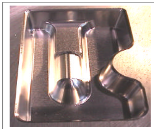
従来工法で仕上加工した キャビ形状 材質 HPM7 硬さ 33HRC 寸法 205 x 138 x 40 H
